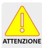
Le tensioni del generatore fotovoltaico sono molto elevate. Non collegare o scollegare MAI i connettori DC quando l'inverter è in funzionamento altrimenti potrebbero innescarsi pericolosi archi elettrici.
