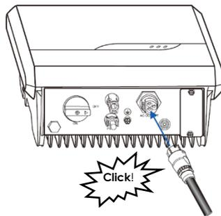
8. Nel caso in cui il connettore AC debba essere rimosso utilizzare un cacciavite per premere la linguetta laterale per liberarla; sfilare il connettore verso il basso.
