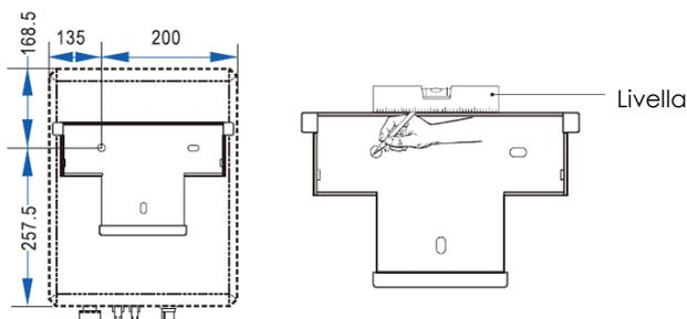
2. Inserire i tasselli nei fori utilizzando un martello di gomma. Posizionare la staffa e inserire le viti per bloccarla. Avvitare con coppia di 2-2.5Nm.
