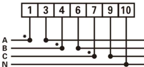
Notare che l'ingresso del meter è composto dalle porte 1, 4, 7, poste sulla parte inferiore del meter, che devono essere collegate lato rete mentre l'uscita è composta dalle porte 3,6,9 che devono essere collegate lato inverter.
