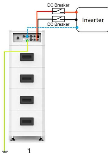
Si raccomanda di inserire un sezionatore DC da almeno 80 A fra batteria e inverter
