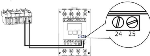
Inserire poi il connettore a 6 poli nella porta denominata "RS485" (posta sotto il coperchio di protezione IP65). Una volta installato correttamente l'energy meter, devono essere eseguite alcune configurazioni mediante l'app HQLink come spiegato al cap. 7.
