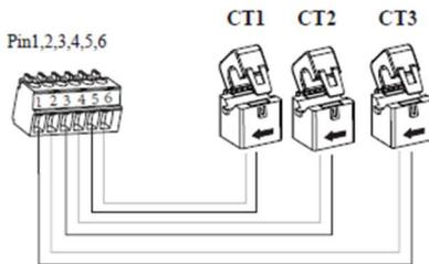
Prestare attenzione che ciascun toroide sia posto intorno ad un singolo filo di fase e rispettare l'ordine delle fasi (L1, L2, L3 riportata sui toroidi). Non è possibile porlo ad abbracciare due o più fili di derivazione della stessa fase. In tal caso, bisogna inserirlo più a monte, prima di qualsiasi derivazione. Prestare anche attenzione a che non ci siano derivazioni
