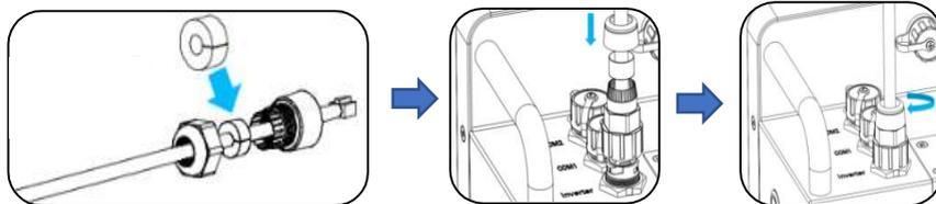
Collegare tramite i cavi di potenza una delle uscite P+ della batteria con la porta Bat+ dell'inverter e una delle porte P- della batteria con la porta Bat- dell'inverter secondo lo schema sotto riportato:
