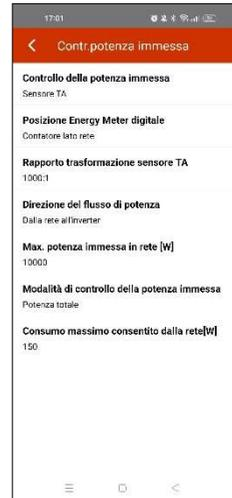
L’operazione di modifica della “Modalità di controllo della potenza immessa” va eseguita ad inverter spento.
