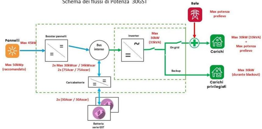
Come si può notare, la massima potenza di ingresso DC eccede largamente sia la potenza di uscita verso la rete e i carichi, sia la potenza del caricabatteria. Questa maggiore capacità del circuito di ingresso può essere sfruttata per ricaricare la batteria mentre contemporaneamente si fornisce potenza ai carichi o alla rete. Qualsiasi combinazione di potenza di uscita e di caricabatterie è accettabile purché:
