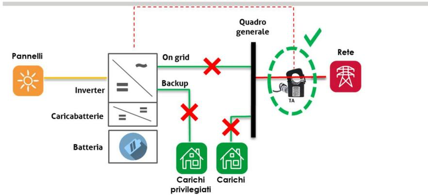
Notare che i toroidi sono dotati di una freccia per indicare il senso di scorrimento della corrente che corrisponde ad una lettura di valore positivo. I toroidi vanno inserito in modo che la freccia sia orientata dal contatore di utenza al quadro generale (da rete ad inverter).
